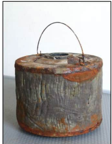
Stark verschmutztes und verschlammtes Filterelement
